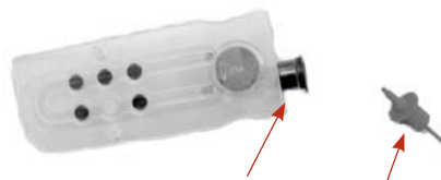
Abbildung 4. Füllöffnung für Proben und Spritzenadapter
