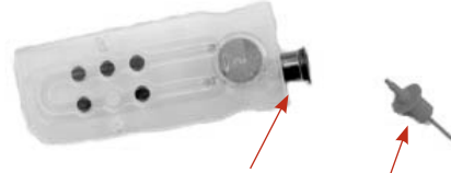
Abbildung 16. Füllöffnung für Proben und Spritzenadapter
