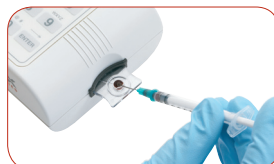
Abbildung 2: Probe in die mittlere Probenvertiefung geben.
